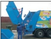
Перегрузка отходов из контейнеров объемом 8м<sup>3</sup>.
