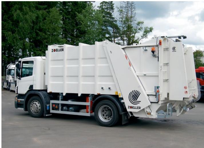
Мусоровозы на шасси Scania идеально подходят для сбора и транспортировки ТБО и КГМ. Высокая эффективность техники обусловлена высокой степенью сжатия ТБО (1:7) и скоростью обслуживания контейнеров.
