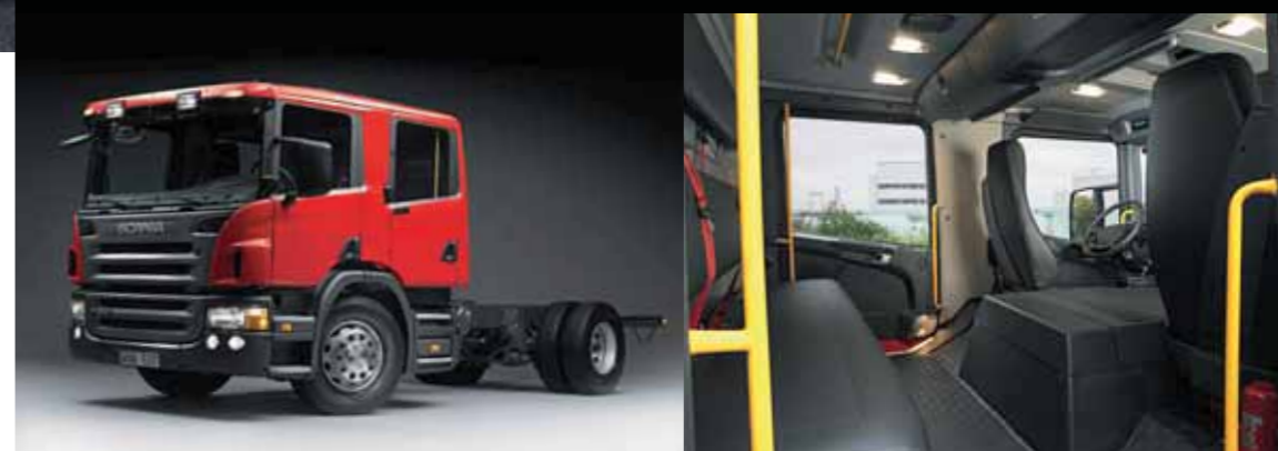
Кабины для экипажей Р-серии могут устанавливаться на автомобилях с самыми различными расстояниями между осями и колесными формулами, причем все они поступают к потребителю непосредственно с заводского конвейера.
